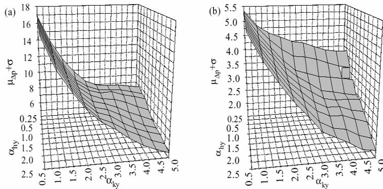
Figura 4. Demandas de ductilidad promedio más la desviación estándar para estructuras con  $C_y=0.1, Z=2, T_y=0.2$  seg (a) y  $C_y=0.1, Z=2, T_y=0.6$  seg (b) analizadas con el modelo bilineal.
