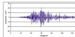
Figura 15. Acelerograma registrado en el suelo firme bajo la nave de prensa aislada del periódico REFORMA.
