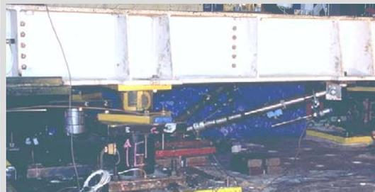
**SHAKE TABLE TESTING OF SEISMICALLY ISOLATED
